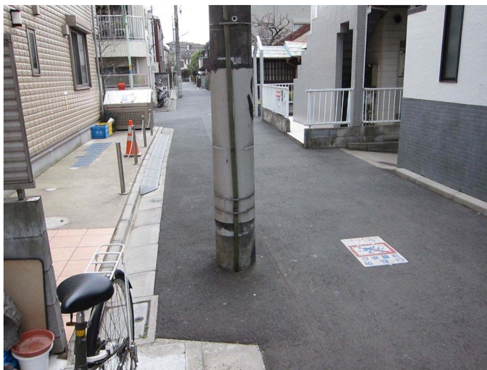
写真 セットバック後も道路内に残る電柱
